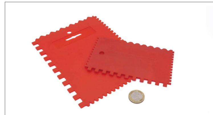
Zahnpachtel aus Polypropylen eignen sich hervorragend zum Aufbringen von Klebstoffen bei der Fliesen- oder Bodenverlegung (Teppichböden, PVC-Beläge, Laminatböden) Polypropylen ist lösungsmittelbeständig (problemlose Reinigung), abriebfest und problemlos recycelbar.
